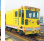
遠隔制御車「RC701C号車」 道床砕石や残土を積載し、低床トロリの端部で活躍します。
