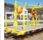
低床トロリ「3E号車」 定尺レールやPCまくら木などを運搬します。
