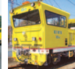
モーターカー「105D号車」 ダンプロリなどを牽引し、レールや砕石を運搬します。
