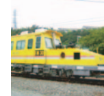
軌道検測車「EM30」 軌間、水準、高低、通り、平面性を検測します。
